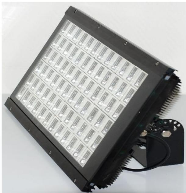
Светильник тоннельный на полупроводниковых источниках света (светодиодах). Светильник предназначен для освещения улиц, ЖД станций, магистралей, придворовых территорий, парков и иных объектов инфраструктуры жилых и промышленных зон. Оптимальный вариант установки: на подвесе или опоре высотой 6 - 9м, рабочий температурный диапазон: от -40С<sup>0</sup> до +85С<sup>0</sup>
